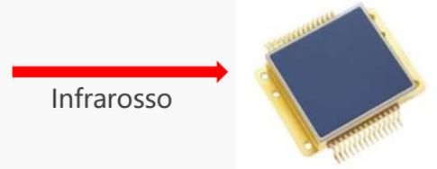
La termocamera è costituita da una lente al germanio, un rivelatore a infrarossi, un circuito di elaborazione del segnale, un chip di elaborazione delle immagini e un guscio metallico. Esistono molte configurazioni di rivelatori ad infrarossi, da 80x60 a 1280x1024, che è la risoluzione della termocamera.
