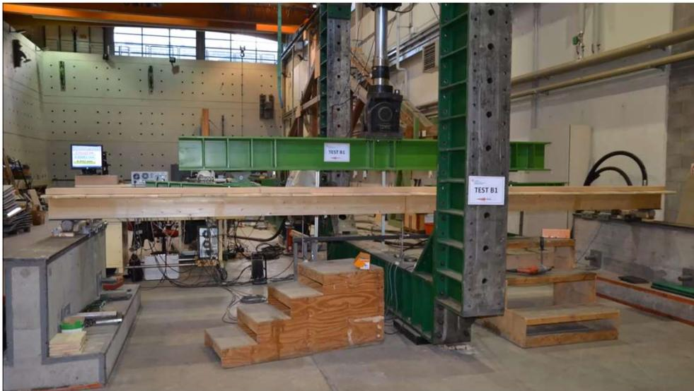
**SOLAI COMPOSTI LEGNO-LEGNO «PRECOMPRESSI» | TEST A ROTTURA**
