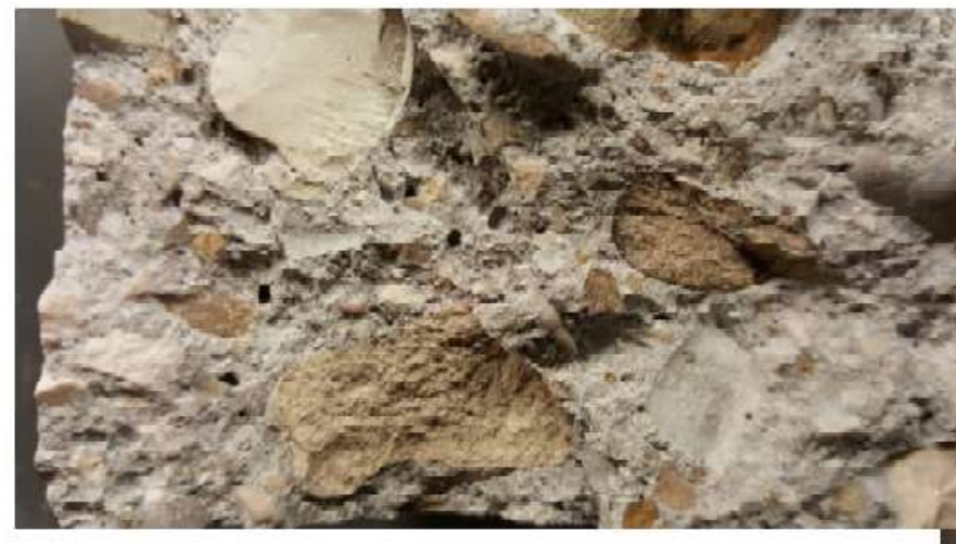
Fig. 9 Dettaglio della porosità visibile sulla carota 1
