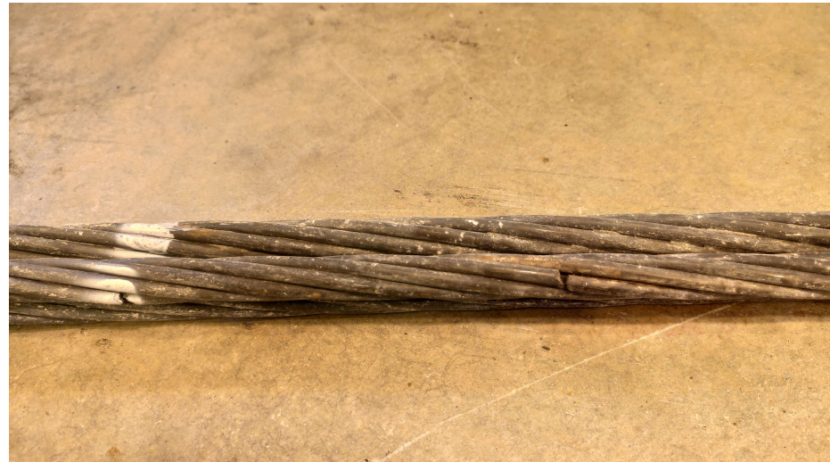
Frattura duttile – trave T5a
