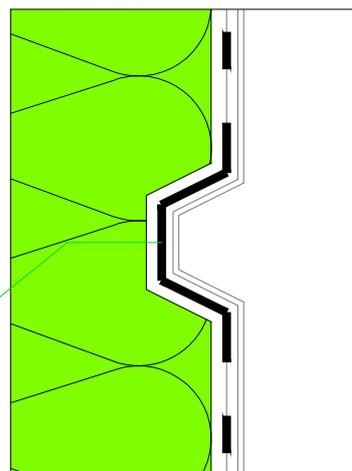
**NOTA:** I profili per riseghe vanno sempre sovrapposti con la rete di armatura per almeno 10 cm
