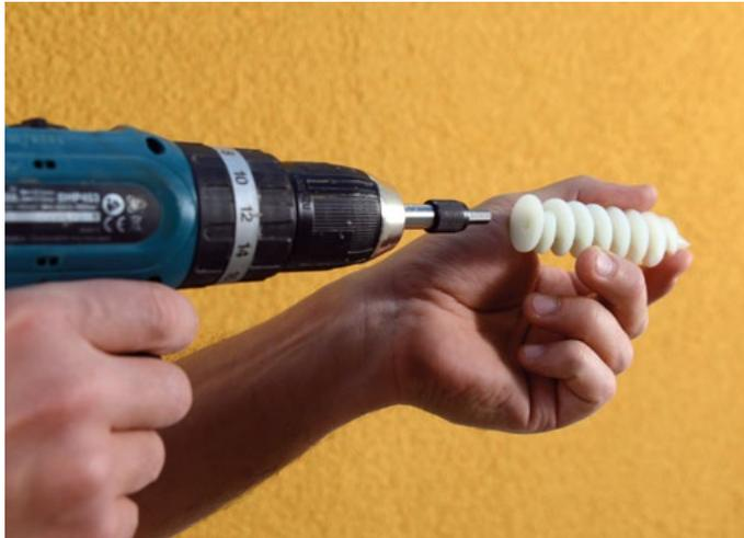
Per l'applicazione di carichi particolarmente leggeri al sistema a cappotto è possibile utilizzare l'apposito tassello autofilettante, senza preforo. Applicare sull'avvitatore l'apposita punta, in base all'inserto presente sull'elemento di fissaggio per carichi leggeri.
