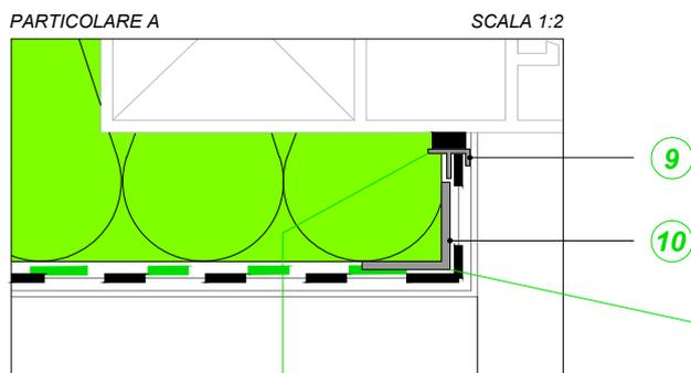
Qualora la rete di collegamento dell'angolare non si sovrapponga (almeno parzialmente) alla rete di collegamento del profilo per finestre, prevedere l'applicazione di una striscia di rete di armatura per armare in continuità architravi e spallette.
