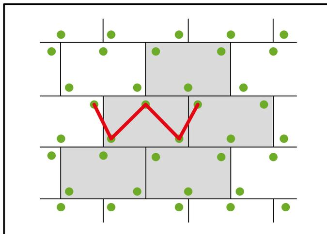
Nella maggior parte delle applicazioni è sufficiente prevedere un minimo di 6 tasselli al m<sup>2</sup> disposti secondo lo schema di tassellatura W. In questo schema ogni tassello è posizionato all'interno del pannello isolante in lana minerale per evitare l'eccessivo schiacciamento dei bordi dello stesso
