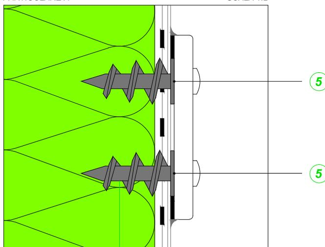
Elemento in polipropilene per il fissaggio di carichi leggeri direttamente sul cappotto ultimato. Specifico per applicazioni elettriche ed illuminazione
