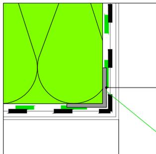
Qualora la rete di collegamento dell'angolare non si sovrapponga (almeno parzialmente) alla rete di collegamento del profilo per finestre, prevedere l'applicazione di una striscia di rete di armatura per armare in continuità architravi e spallette.
