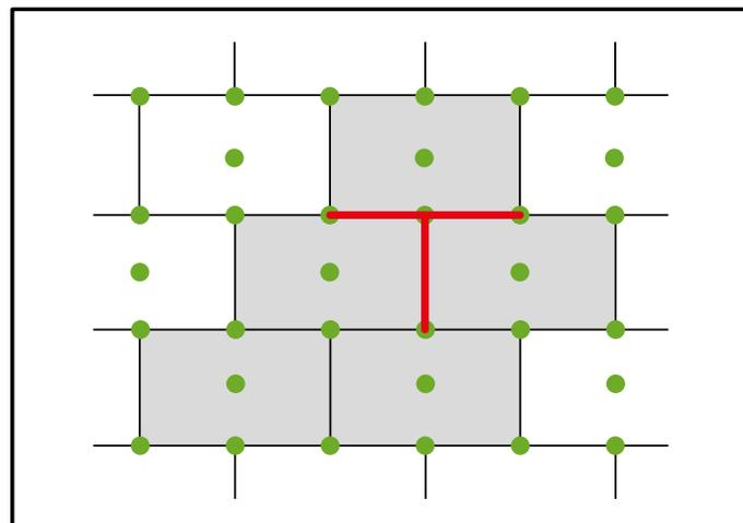
Nella maggior parte delle applicazioni è sufficiente prevedere un minimo di 6 tasselli al m<sup>2</sup>, disposti secondo lo schema di tassellatura a "T". In questo schema si posiziona un tassello in ogni intersezione di pannello, più un tassello al centro di ogni pannello.
