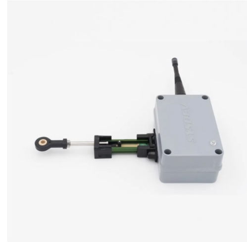
Sensore di spostamento a filo
