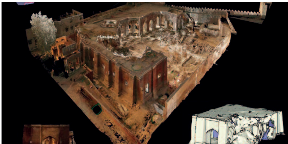
3. Scansione laser 3D di Lahore Fort Royal Kitchens per comprendere la struttura per la sua conservazione.
