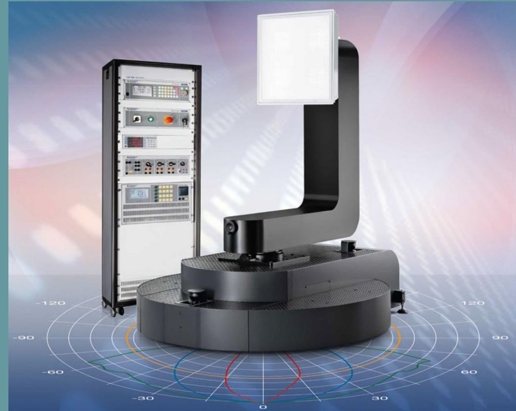
Le curve fotometriche espresse in **cd/Klm (candele per kilolumen)**, esprimono quante candele vengono emesse per ogni 1000 lumen di flusso della lampada. Per ottenere il valore assoluto bisogna moltiplicare il valore letto della curva per il flusso della lampada diviso 1000.
